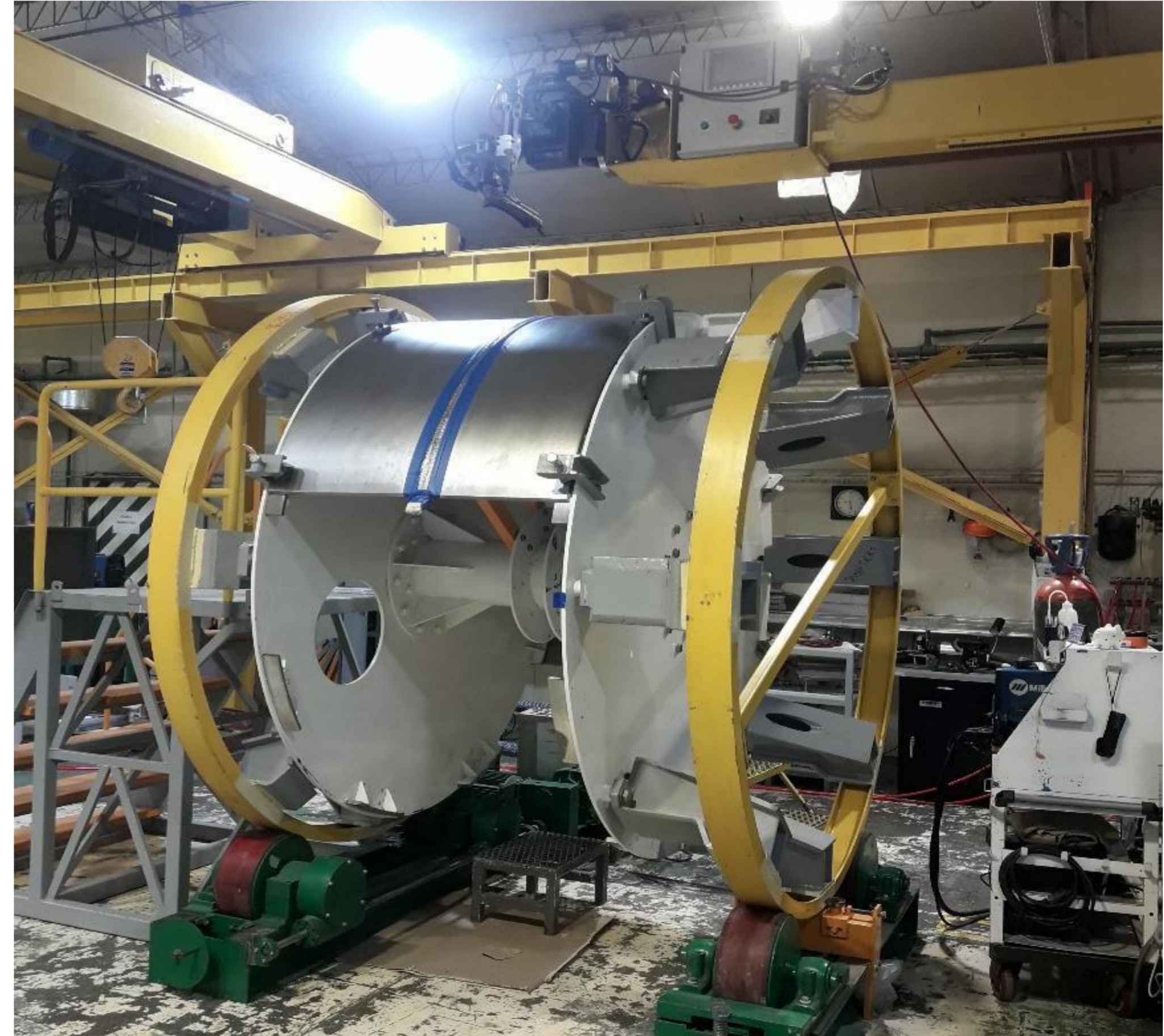
Fabricación tanque reflector
