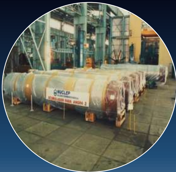
Acumuladores Angra II
