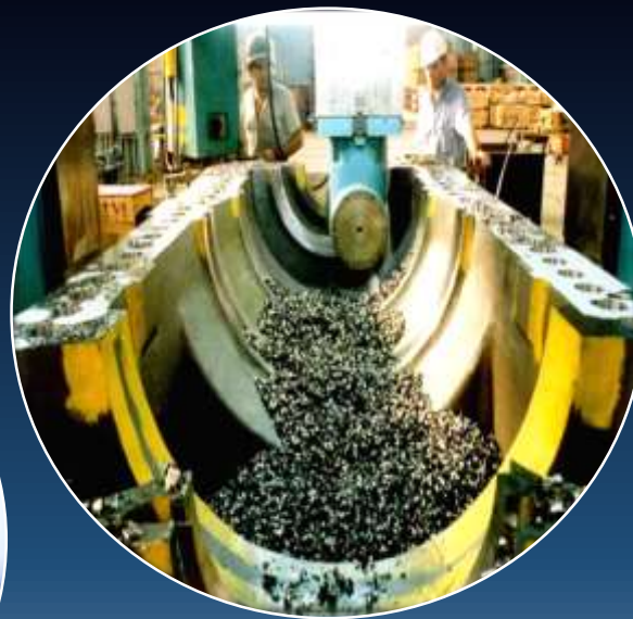
Carcças de Exaustão para turbinas a Gás
