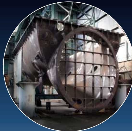
Condensadores Angra III
