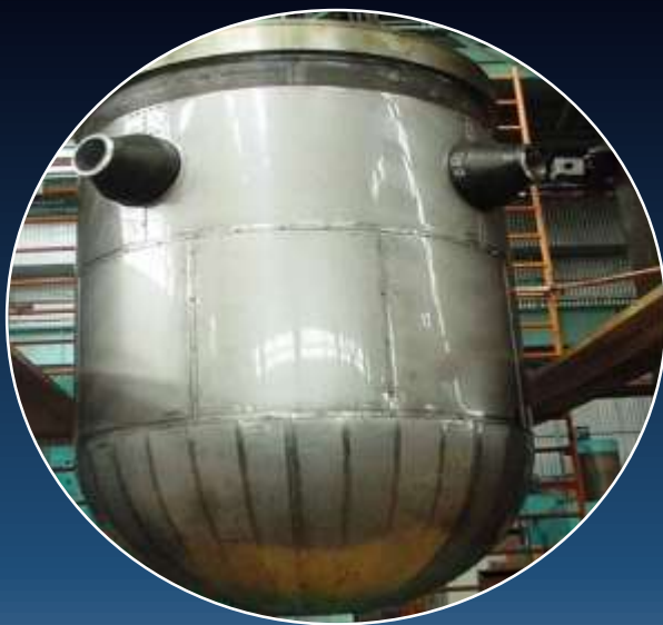
Vaso de Pressão do Reator - CTMSP
