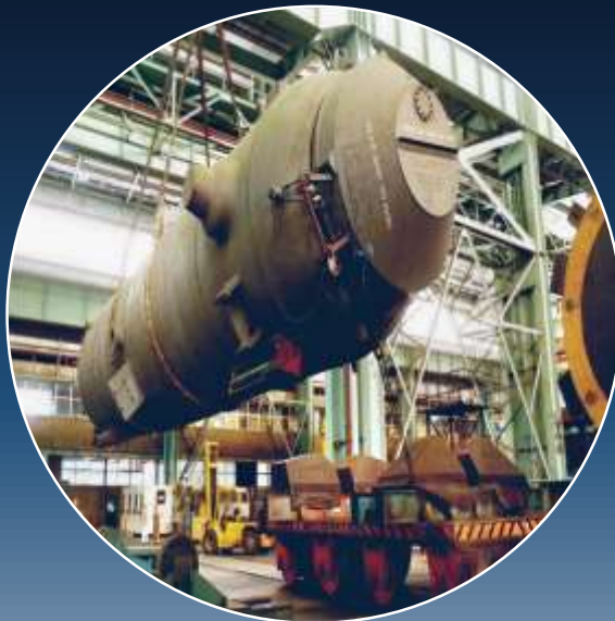
Pressurizador para Angra III
