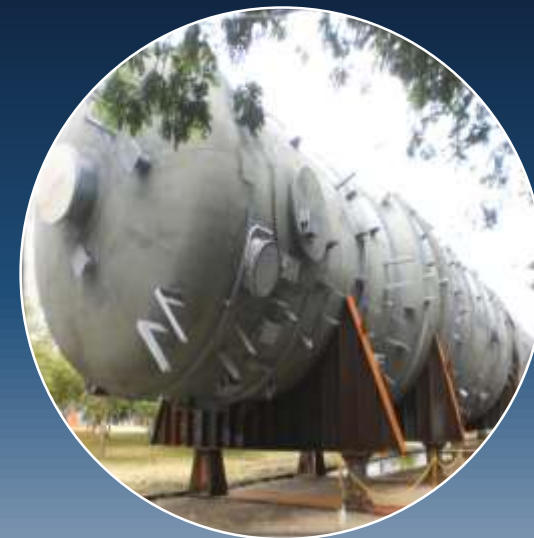
Torres de destilação atmosférica e à vácuo
