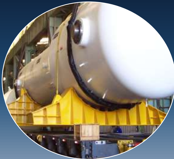
Geradores de Vapor para Angra I
