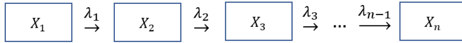
Figura 1. Cadena de decaimiento lineal propuesta por Bateman. Los X_i representan los elementos de la cadena, y las \lambda_i son sus constantes de decaimiento.
