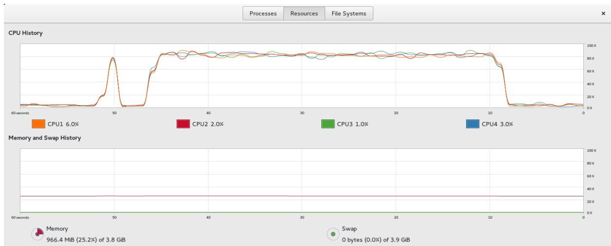
Figura 5. Uso de CPU durante la ejecución en paralelo de los canales termohidráulicos
