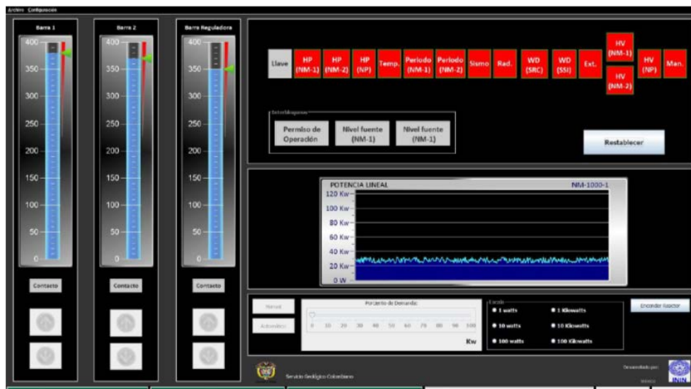
Figura 5. Pantalla de Control del Reactor.
