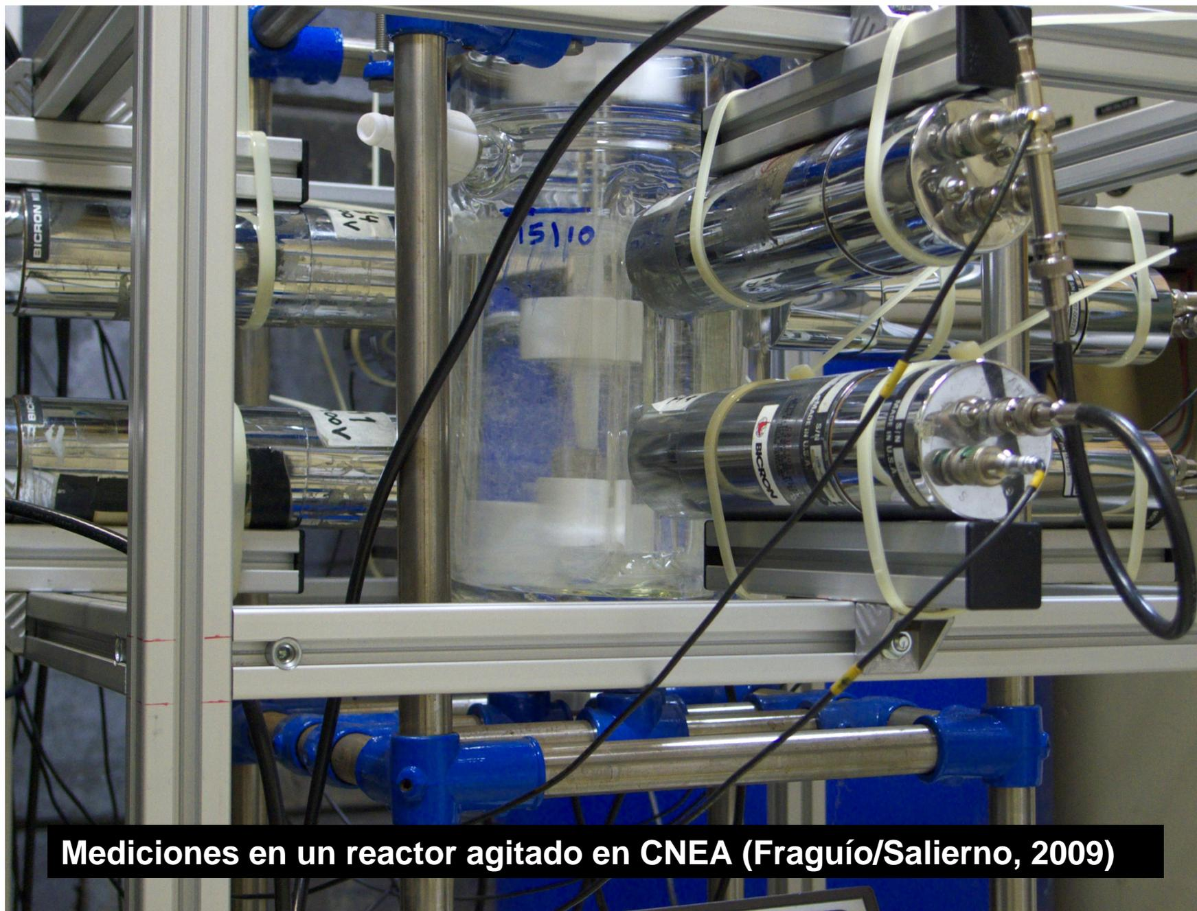
**Mediciones en un reactor agitado en CNEA (Fraguío/Salierno, 2009)**
