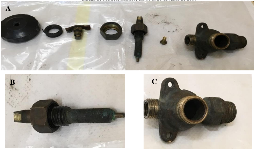
Figura 7. Imágenes de la pieza 1 real contaminada desarmada en partes (A), así como el vástago (B) y carcasa (C) contaminadas.
